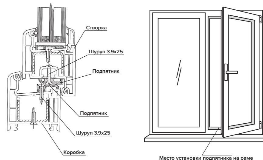
Оконные блоки из ПВХ-профиля оборудованы поворотно-откидным устройством с функцией щелевого проветривания, которое управляется единой ручкой.
