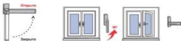
Для перевода створки из закрытого положение в откидное (поворот створки относительно нижней горизонтальной оси, положение «Откинута») ручку поворачивают вертикально на 180 градусов вверх, затем, потянув за ручку, поворачивают створку относительно нижней горизонтальной оси на заданный изготовителем угол (не более 10 градусов) (откидной режим).
