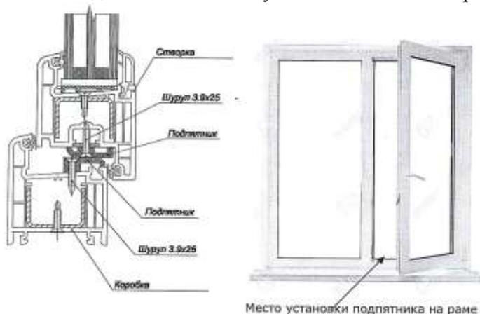
Оконные блоки из ПВХ-профиля оборудованы поворотно-откидным устройством с функцией щелевого проветривания, которое управляется единой ручкой:
