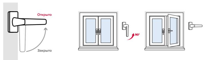
Для перевода створки из закрытого положение в откидное (поворот створки относительно нижней горизонтальной оси, положение «Откинуто») ручку поворачивают вертикально на 180 градусов вверх, затем, потянув за ручку, поворачивают створку относительно нижней горизонтальной оси на заданный изготовителем угол (не более 10 градусов) (откидной режим).
