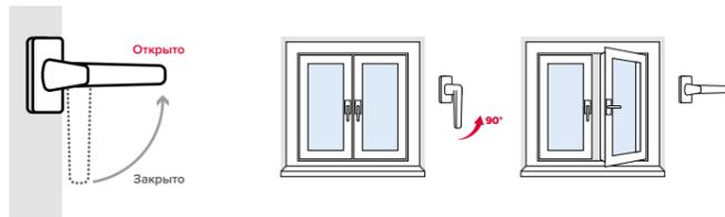
Для перевода створки из закрытого положение в откидное (поворот створки относительно нижней горизонтальной оси, положение «Откинута») ручку поворачивают вертикально на 180 градусов вверх, затем, потянув за ручку, поворачивают створку относительно нижней горизонтальной оси на заданный изготовителем угол (не более 10 градусов) (откидной режим).
