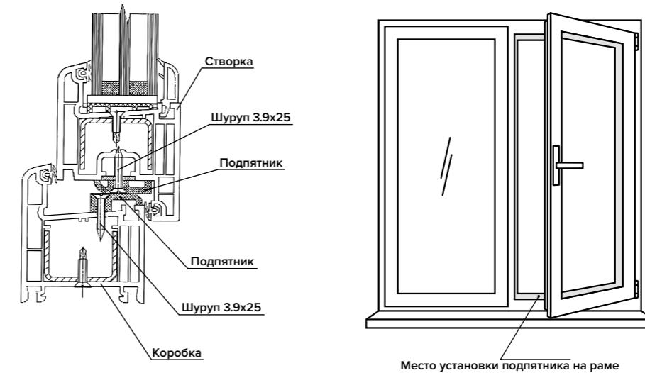
Оконные блоки из ПВХ-профиля оборудованы поворотно-откидным устройством с функцией щелевого проветривания, которое управляет единой ручкой.
