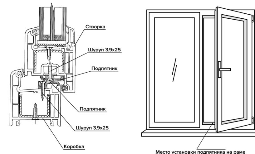
Оконные блоки из ПВХ-профиля оборудованы поворотно-откидным устройством с функцией целевого проветривания, которое управляется единой ручкой.
